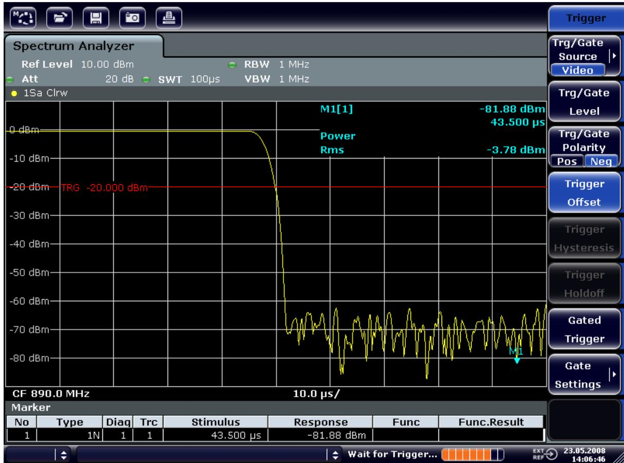
Fig. 6-10 : Front descendant du burst GSM à haute résolution temporelle
